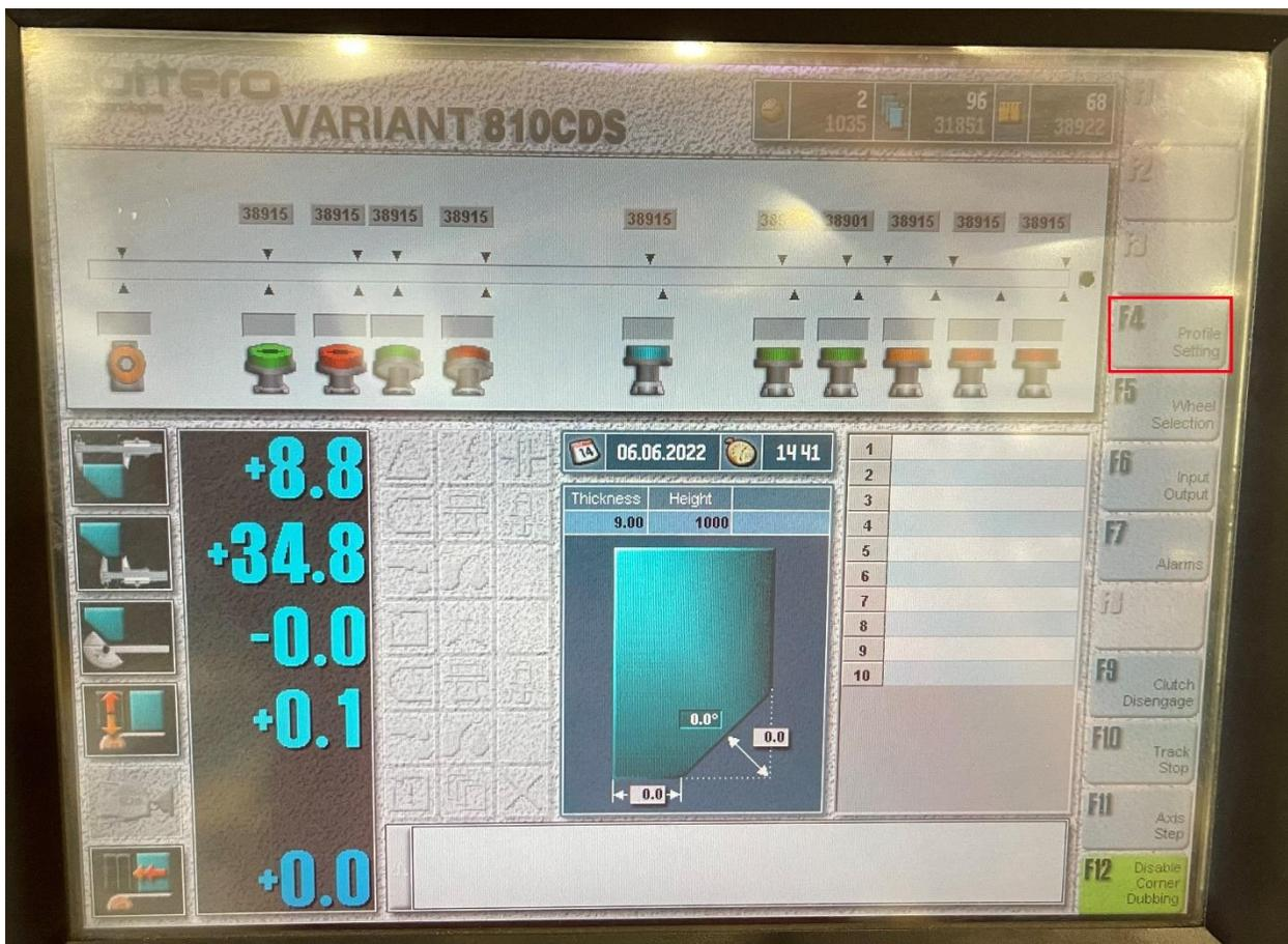
Para configurar el espesor de un vidrio, seleccionar la opcion Profile Setting, luego ingresar el espesor del vidrio en Thickness, notese que siempre que se vaya a cambiar de espesor de vidrio, se debe medir este espesor con un calibrador. Notese que en la pantalla aparecera el espesor del
