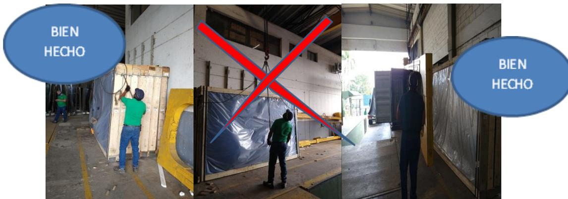
**Tercera etapa:** Cuando el huacal se pasa de un lado de la bodega al otro, se coloca en un burro de transición ubicado en la puerta que los comunica, este burro está montado sobre dos rieles anclados en el piso, Entonces el burro se coloca en el extremo diferente al origen del huacal, una vez colocado se asegura la carga con una cuerda resistente y se desplaza el burro por los rieles hasta el otro extremo que está ubicado en el lado de destino del huacal, se toma con unas guayas
